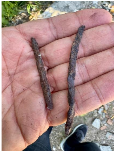
Εικόνα 2: (c) μείωση της διατομής ράβδου οπλισμού λόγω τοπικής (pitting) διάβρωσης, (d) ψαθυρή αστοχία τενόντων προέντασης εξαιτίας υδρογονοευθραυστότητας.
