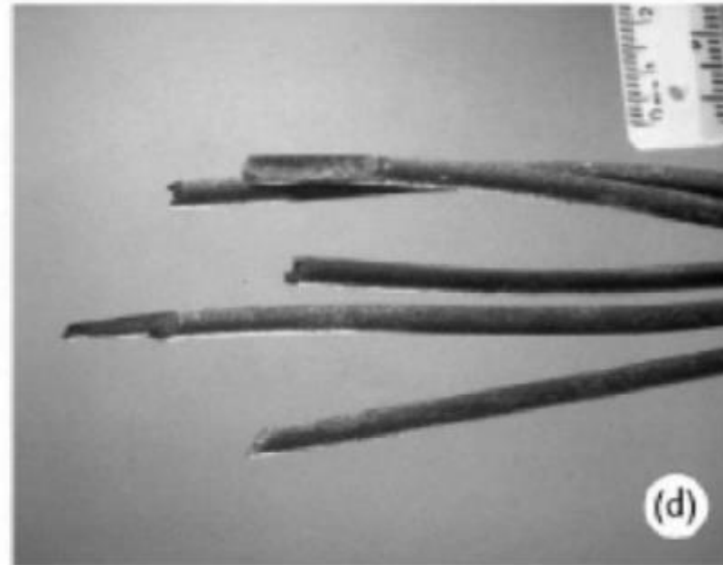
Εικόνα 2: (c) μείωση της διατομής ράβδου οπλισμού λόγω τοπικής (pitting) διάβρωσης, (d) ψαθυρή αστοχία τενόντων προέντασης εξαιτίας υδρογονοευθραυστότητας.
