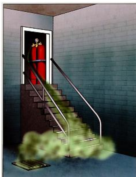
Εικόνα 1: Παράδειγμα συγκέντρωσης υγραερίου σε υπόγειους χώρους ή σε λάκκους αποχετεύσεων
