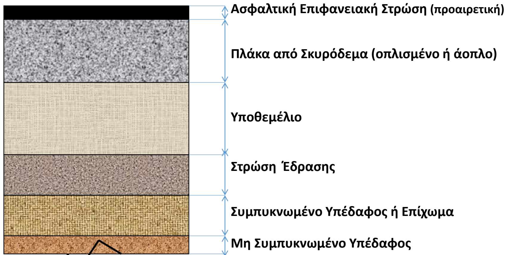
Τυπική Τομή Άκαμπτου Οδοστρώματος
